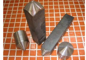
En el presente reconocimiento las pruebas se han realizado con un penetrómetro dinámico portátil sobre orugas con golpeo automático de la marca TECOINSA.
